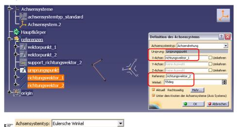
Achsensystemtyp Eulersche Winkel Bei der Definition eines Achsensystems des Typs *Eulersche Winkel (Euler Angles)* findet eine Transformation von Achsen über die Angabe von Winkeln um Referenzachsen statt. Der Ursprungspunkt kann frei gewählt werden, die Winkelwerte werden allerdings gegenüber dem Hauptkoordinatensystem definiert.
